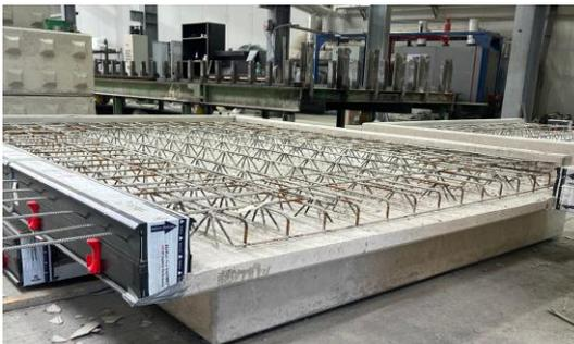
Im Betonwerk BWH in Holdorf produzieren wir Sonderbauteile wie Balkenelemente mit umlaufender Aufkantung, Stützen, Unterzüge für den Hochbau. In Kooperation mit dem Betonwerk BWS in Sulingen können wir auch Treppenanlage anbieten.
